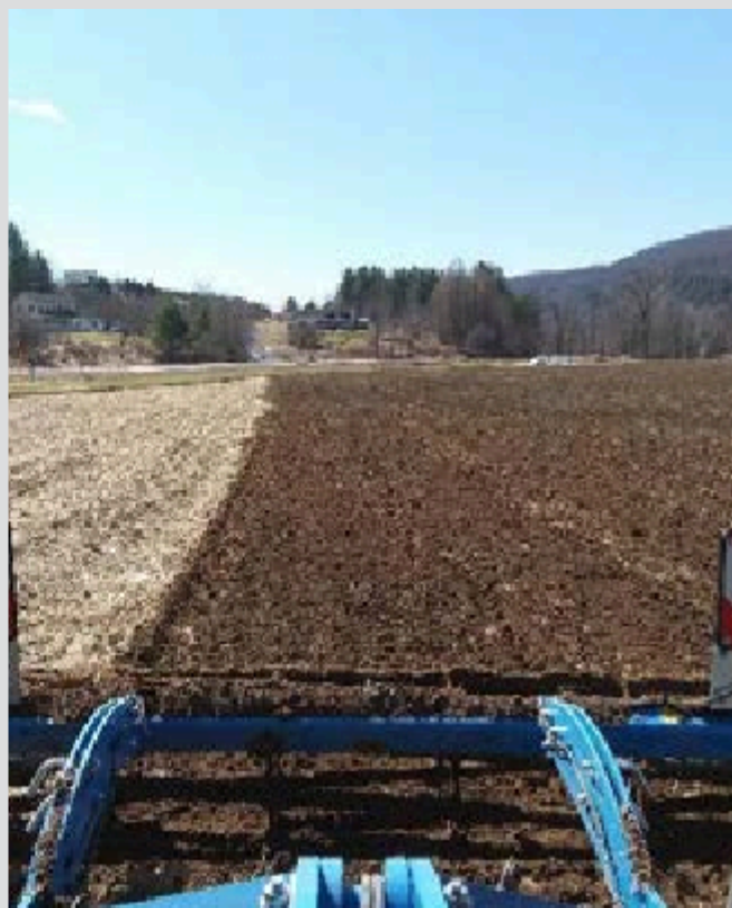
Figura 6. Para la mayoría de las operaciones de labranza, Burnt Rock Farm usa un disco de alta velocidad Farmet Softer de 2.5 metros (8 pies) equipado con discos dentados, montados independientemente sobre resortes y de ángulo compuesto, y una canasta rodante de ajuste de profundidad en la parte trasera. Trabajando de 3 a 4 pulgadas de profundidad a una velocidad de avance de 7-8 mph, el disco pica e incorpora los cultivos de cobertura segados con mayales (izquierda) y prepara una cama satisfactoria para el trasplante en dos pasadas con 10 días de diferencia. Los cultivos de cobertura muertos por el invierno requieren solo una pasada (derecha). Debido a que el disco funciona mejor en suelo húmedo, Justin incorpora las coberturas de mediados de verano después de una lluvia.
