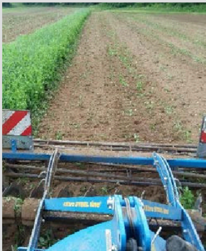
Figura 6. Para la mayoría de las operaciones de labranza, Burnt Rock Farm usa un disco de alta velocidad Farmet Softer de 2.5 metros (8 pies) equipado con discos dentados, montados independientemente sobre resortes y de ángulo compuesto, y una canasta rodante de ajuste de profundidad en la parte trasera. Trabajando de 3 a 4 pulgadas de profundidad a una velocidad de avance de 7-8 mph, el disco pica e incorpora los cultivos de cobertura segados con mayales (izquierda) y prepara una cama satisfactoria para el trasplante en dos pasadas con 10 días de diferencia. Los cultivos de cobertura muertos por el invierno requieren solo una pasada (derecha). Debido a que el disco funciona mejor en suelo húmedo, Justin incorpora las coberturas de mediados de verano después de una lluvia.
