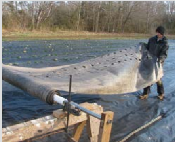
Figura 3. Para colocar y recoger la tela para paisajismo de manera eficiente y reducir la mano de obra, Bryan utiliza un sencillo carrete casero para enrollar la tela. La tela de 6 pies de ancho se coloca sobre camas elevadas con una separación de 5 pies de centro a centro, superponiéndose en los pasillos y fijándose con grapas metálicas de 8 pulgadas. Crédito de la fotografía: Bryan Hager
