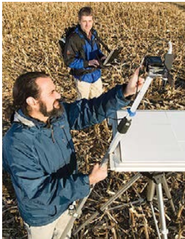
El científico de suelos Guy Serbin (izquierda) y el especialista en teledetección Any Russ calibran un espectrorradiómetro portátil sobre un panel blanco antes de medir la reflectancia de los residuos de cultivos y suelos en un campo de maíz. Estas mediciones de reflectancia basadas en tierra se utilizan para desarrollar herramientas de teledetección para evaluar la intensidad de la labranza del suelo usando imágenes de satélite y de aeronaves. Foto de Peggy Greb.
