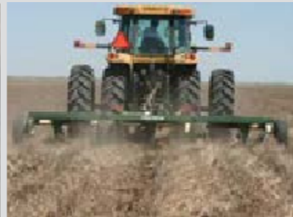
Figura 9. El arado de cuchilla o arado de barrido (sweep plow undercutter) elimina los cultivos de cobertura y las malezas al cortar la corona de las raíces justo por debajo de la superficie, dejando los residuos sobre el terreno y la mayor parte del perfil del suelo sin alteración. Esta herramienta requiere un nivel de humedad del suelo muy preciso, ya que en condiciones húmedas la vegetación puede volver a crecer, mientras que en condiciones muy secas la herramienta no penetra lo suficiente para eliminar el cultivo de cobertura. "Funciona aproximadamente el 50 % de las veces para terminar el barbecho verde", dijo Doug. "Mi alternativa cuando no funciona es usar el disco rápido (speed disk)". Fotos: Drew Lyon, Universidad de Nebraska.
