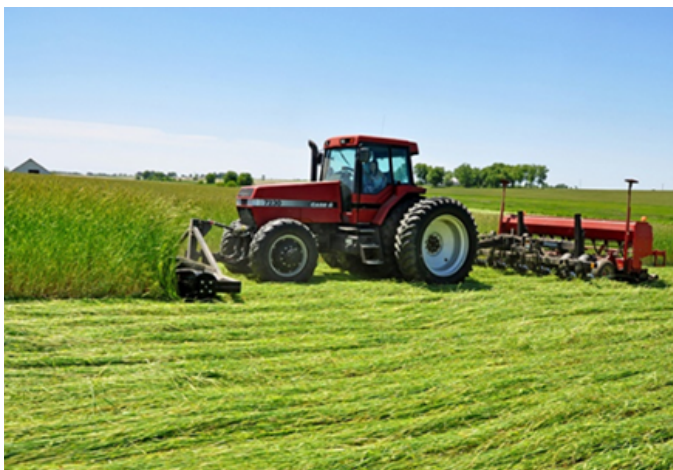
Rodillo crimpador en la parte delantera, sembradora de labranza cero en la parte trasera. Crédito de la foto: Jason Johnson, USDA/NRCS
